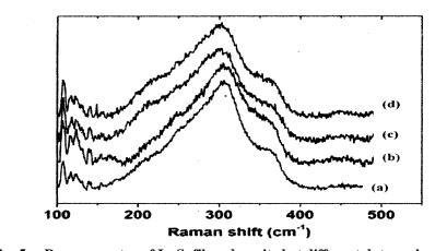
Fig: 5. – Raman spectra of  $In_2S_3$  films deposited at different duty cycles (a) 50 % (b) 33 % (c) 15 % (d) 6 %
