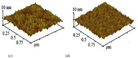
Fig: 4. – Atomic force micrographs of  $In_2S_3$  films deposited at different duty cycles (a) 6 % (b) 15 % (c) 33 % (d) 50 %
